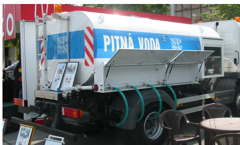
Obr. 2. Cisterna pre náhradné zásobovanie pitnou vodou (foto: Jurík)
